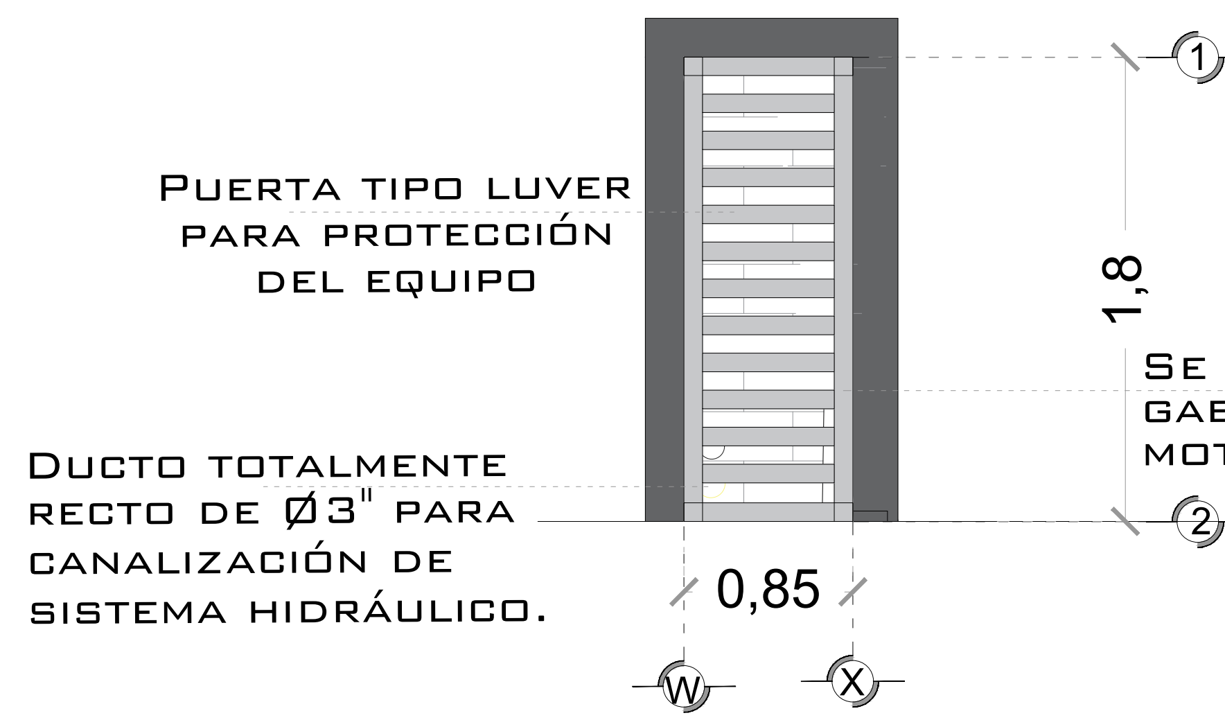
DESCRIPCION DE UNIDAD HIDRAULICA GABINETE (VISTA FRONTAL)
