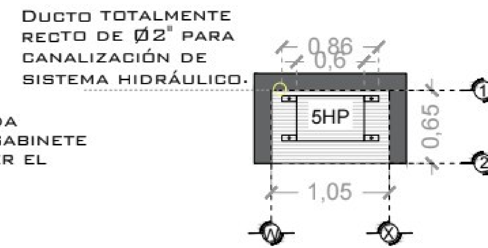
DESCRIPCIÓN DE UNIDAD HIDRAULICA GABINETE (VISTA PLANTA)
