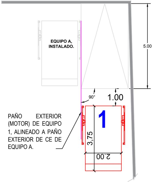
PAÑO EXTERIOR (MOTOR) DE EQUIPO 1, ALINEADO A PAÑO EXTERIOR DE CE DE EQUIPO A.
