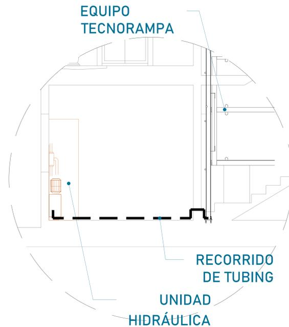
Para la alimentación del equipo se requiere una Unidad Hidráulica, se requiere que este motor este lo mas cerca posible del equipo, por lo tanto se solicita al cliente tener un ducto de 3" para poder pasar ahí el tubing y los cables para la botoneras
