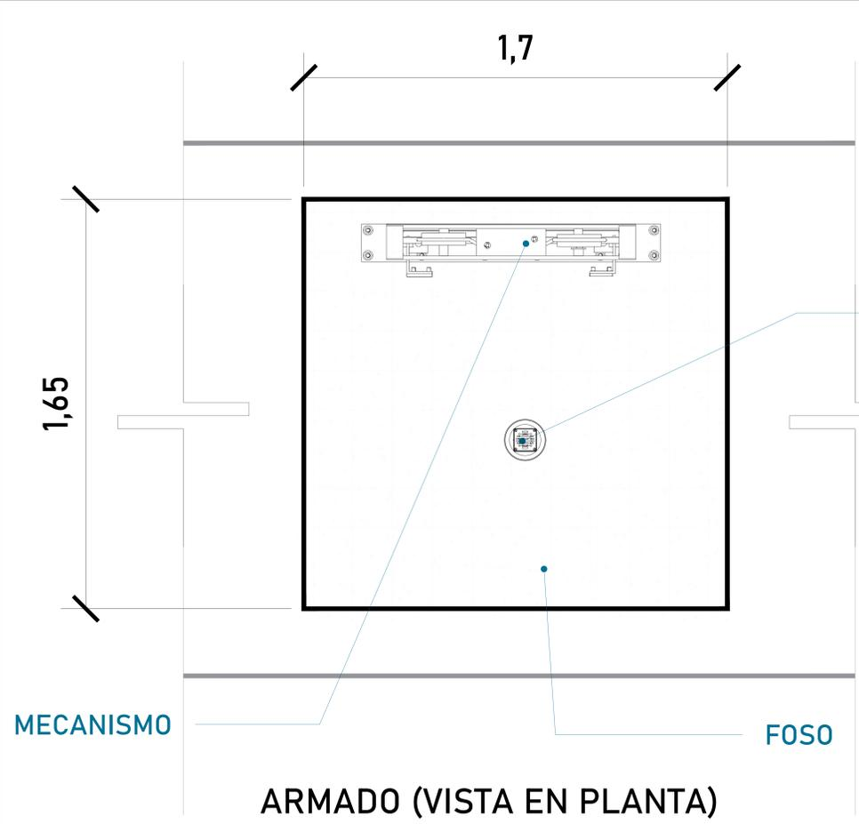
Firme de concreto armado con una resistencia de  $F' C = 250 \text{ kg/cm}^2$ .
