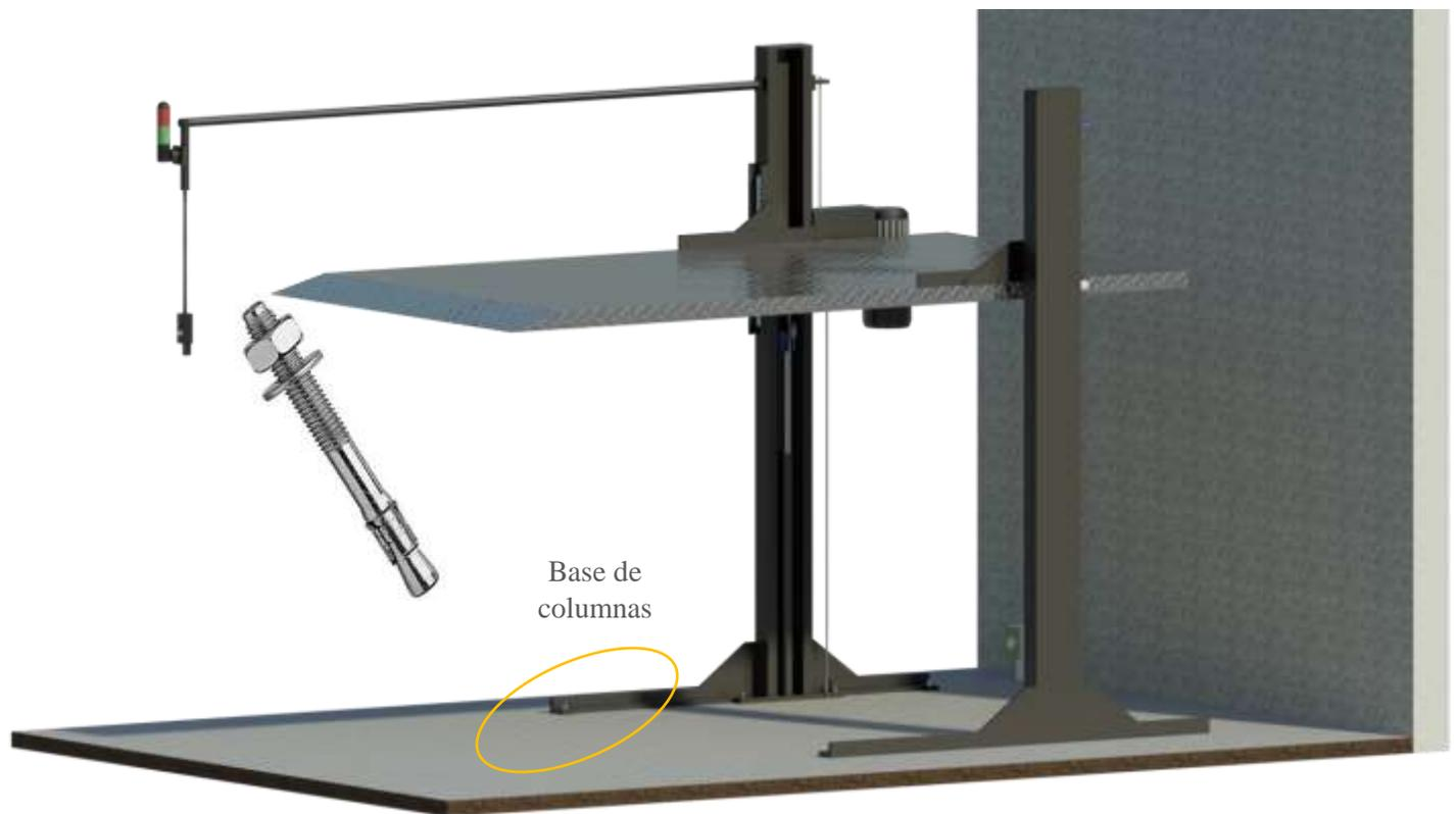
Para la correcta instalación del equipo, es necesario que la base del concreto sea armado con malla electrosoldada 66.10.10, donde se deberá de utilizar concreto con una resistencia de  $f'c=250$  kg/cm<sup>2</sup> y un espesor de 0.15 m
