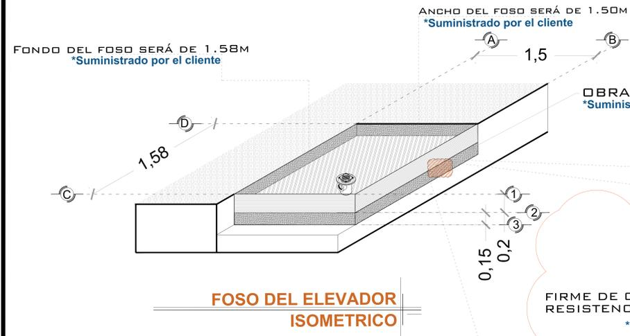
OBRA CIVIL PARA EL ANCLAJE DEL EQUIPO
