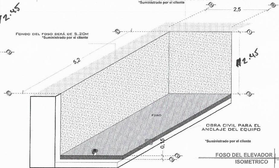
OBRA CIVIL PARA EL ANCLAJE DEL EQUIPO
