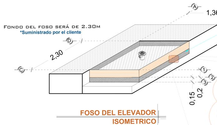
OBRA CIVIL PARA EL ANCLAJE DEL EQUIPO
