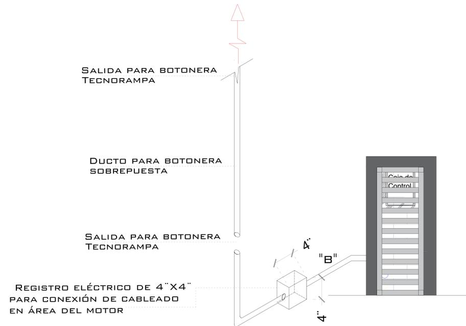
LA DISTANCIA "B" SE CUBRIRÁ DE SER POSIBLE CON DUCTOS REALIZADOS CON TUBERÍA Y LA SALIDA EN EL FOSO SERÁ RECOMENDABLE UBICARLA DEL LADO DONDE SE ENCONTRARAN LAS COLUMNAS Y EL RESTO DE LA ESTRUCTURA DEL ELEVADOR. EN CASO DE QUE NO SE PUEDA INSTALAR ESTOS DUCTOS SE EMPLEARA UNA CANALIZACIÓN DIFERENTE QUE PROTEJA EL CABLEADO. EN CUALQUIERA DE LOS DOS CASOS ESTÁ SERÁ SUMINISTRADA POR PARTE DE TECNORAMPA Y LOS TRABAJOS PARA SU INSTALACIÓN LO HARÁ EL EQUIPO DE LA EMPRESA.
