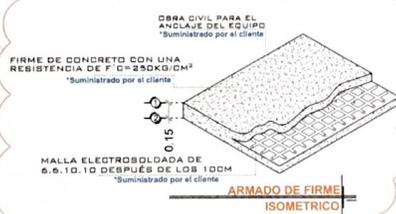
FIRME DE CONCRETO CON UNA RESISTENCIA DE F' C=2500KG/CM²
