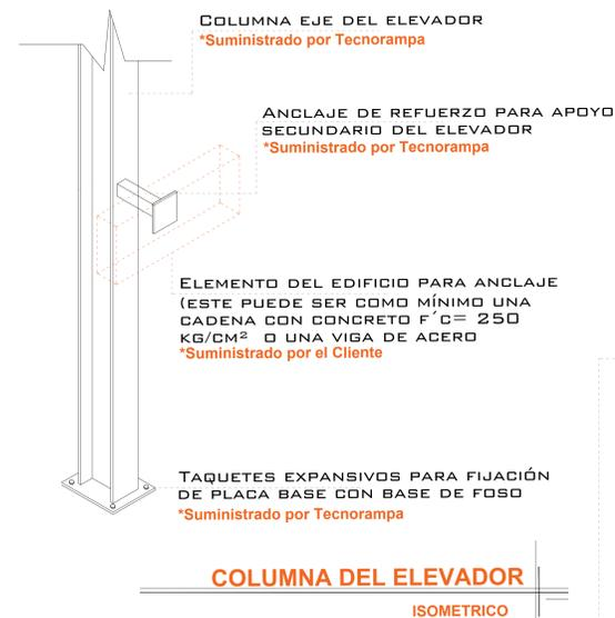
EL MURO DEBERÁ DE SOPORTAR Y DAR FIRMEZA A LA ESTRUCTURA DEL ELEVADOR, SE REQUIERE QUE EL ÁREA DONDE SE COLOQUEN LOS SOPORTES SEA UN MURO COMPLETO DE CONCRETO SI NO ES ASÍ, EL ÁREA DE CONEXIÓN DEBERÁ DE SERLO EMPLEÁNDOSE PARA ELLO UNA TRABE O CADENA DE CERRAMIENTO REFORZADA CON UN PERALTE MÍNIMO DE 15CM.
