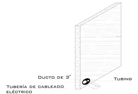
LA DISTANCIA "B" SE CUBRIRÁ DE SER POSIBLE CON DUCTOS REALIZADOS CON TUBERÍA Y LA SALIDA EN EL FOSO SERÁ RECOMENDABLE UBICARLA DEL LADO DONDE SE ENCONTRARÁN LAS COLUMNAS Y EL RESTO DE LA ESTRUCTURA DEL ELEVADOR. EN CASO DE QUE NO SE PUEDA INSTALAR ESTOS DUCTOS SE EMPLEARA UNA CANALIZACIÓN DIFERENTE QUE PROTEJA EL CABLEADO. EN CUALQUIERA DE LOS DOS CASOS ESTÁ SERÁ SUMINISTRADA POR PARTE DE TECNORAMPA Y LOS TRABAJOS PARA SU INSTALACIÓN LO HARÁ EL EQUIPO DE LA EMPRESA.
