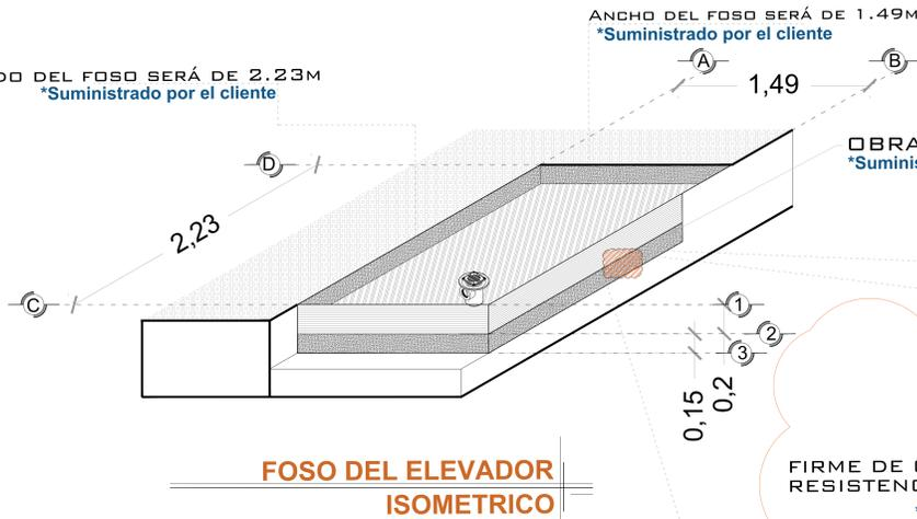
OBRA CIVIL PARA EL ANCLAJE DEL EQUIPO
