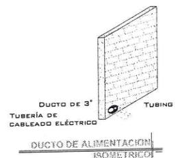
LA DISTANCIA 'B' SE CUBRIRÁ DE SER POSIBLE CON DUCTOS REALIZADOS CON TUBERÍA Y LA SALIDA EN EL FONDO SERÁ RECOMENDABLE UBICARLA DEL LADO DONDE SE ENCONTRARÁN LAS COLUMNAS Y EL RESTO DE LA ESTRUCTURA DEL ELEVADOR. EN CASO DE QUE NO SE PUEDA INSTALAR ESTOS DUCTOS SE EMPLEARÁ UNA CANALIZACIÓN DIFERENTE QUE PROTEJA EL CABLEADO. EN CUALQUIERA DE LOS DOS CASOS ESTÁ SERÁ SUMINISTRADA POR PARTE DE TECNORAMPA Y LOS TRABAJOS PARA SU INSTALACIÓN LO HARÁ EL EQUIPO DE LA EMPRESA.
