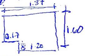
NOTA: FIRME DE CONCRETO DE 15 CM DE ESPESOR CON RESISTENCIA DE 250 KG/CM2. ARMADO CON MALLA ELECTROSOLDADA
