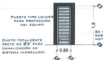
DESCRIPCIÓN DE UNIDAD HIDRÁULICA GABINETE (VISTA FRONTAL)
