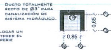
DESCRIPCIÓN DE UNIDAD HIDRÁULICA GABINETE (VISTA PLANTA)
