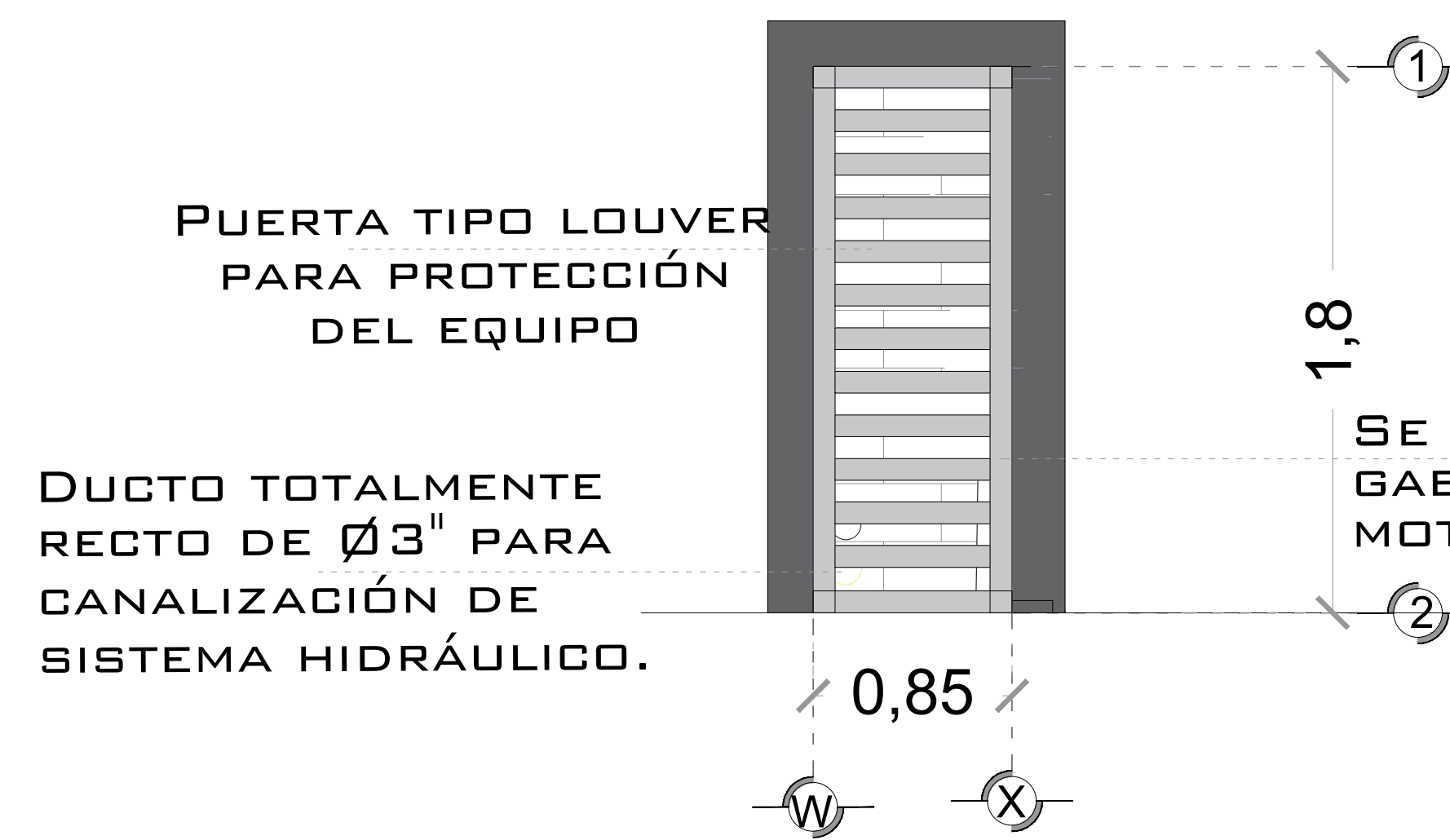
DESCRIPCION DE UNIDAD HIDRAULICA GABINETE (VISTA FRONTAL)
