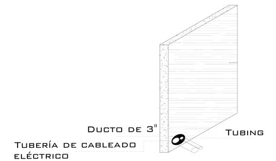
LA DISTANCIA "B" SE CUBRIRÁ DE SER POSIBLE CON DUCTOS REALIZADOS CON TUBERÍA Y LA SALIDA EN EL FOSO SERÁ RECOMENDABLE UBICARLA DEL LADO DONDE SE ENCONTRARAN LAS COLUMNAS Y EL RESTO DE LA ESTRUCTURA DEL ELEVADOR. EN CASO DE QUE NO SE PUEDA INSTALAR ESTOS DUCTOS SE EMPLEARÁ UNA CANALIZACIÓN DIFERENTE QUE PROTEJA EL CABLEADO. EN CUALQUIERA DE LOS DOS CASOS ESTÁ SERÁ SUMINISTRADA POR PARTE DE TECNORAMPA Y LOS TRABAJOS PARA SU INSTALACIÓN LO HARÁ EL EQUIPO DE LA EMPRESA.
