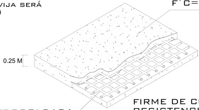
FIRME DE CONCRETO DE 25CM CON UNA RESISTENCIA F'c 250KG/CM2 ARMADA CON MALLA ELECTROSOLDADA 6.6.10.10
