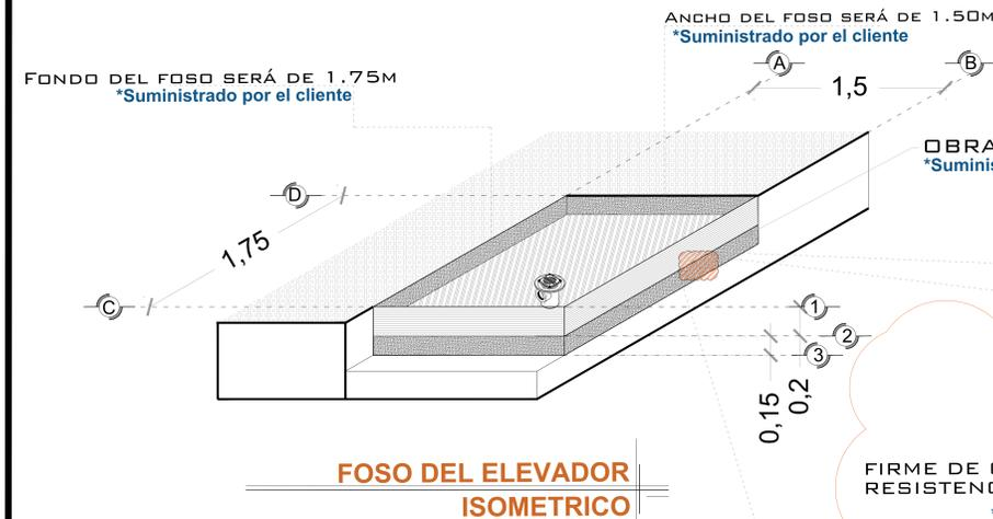
OBRA CIVIL PARA EL ANCLAJE DEL EQUIPO
