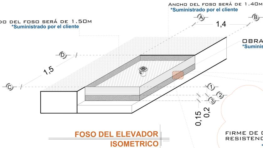
OBRA CIVIL PARA EL ANCLAJE DEL EQUIPO
