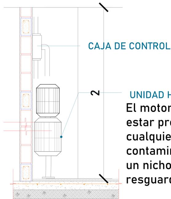
El cliente suministra, instala y energiza centro de carga con alimentación bifásica a 220V, con neutro y tierra física, e interruptor termomagnético de 2 x 30 Amp exclusivo para el elevador, al igual que la canalización de botoneras, las cuales rematan a una caja registro, lo anterior y el centro de carga deberán colocarse en el área donde se ubique la unidad hidráulica y control eléctrico proporcionado por TECNORAMPA a no mayor de 5.00m del área del equipo.
