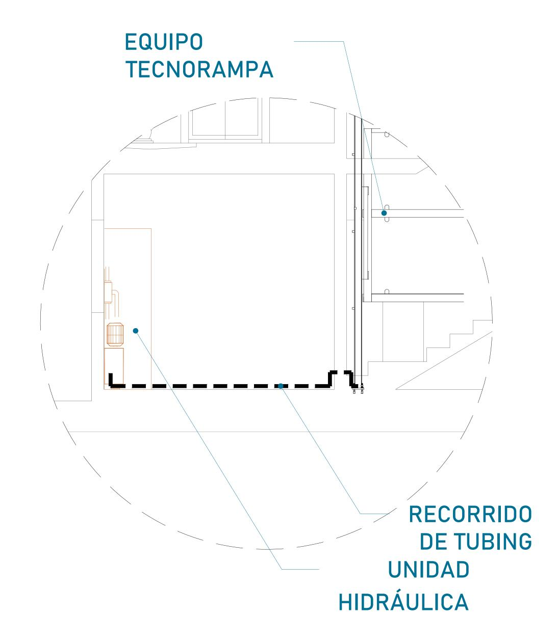
Para la alimentación del equipo se requiere una Unidad Hidráulica, se requiere que este motor este lo mas cerca posible del equipo, por lo tanto se solicita al cliente tener un ducto de 3" para poder pasar ahí el tubing y los cables para la botoneras
