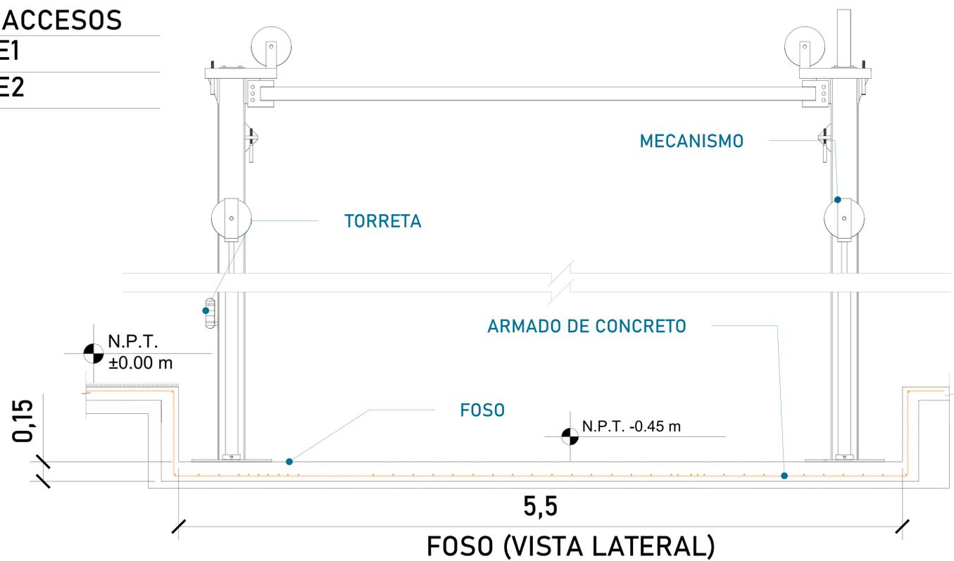
Firme de concreto con una resistencia de  $f'c=250\text{kg/cm}^2$
