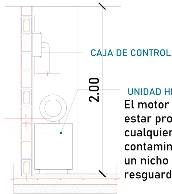
El cliente suministra, instala y energiza centro de carga con alimentación trifásica a 220V, con neutro y tierra física, e interruptor termomagnético de 3 x 40 Amp exclusivo para el elevador, deberá colocarse en el área donde se ubique la unidad hidráulica y control eléctrico proporcionado por TECNORAMPA a no mayor de 5.00m del área del equipo.
