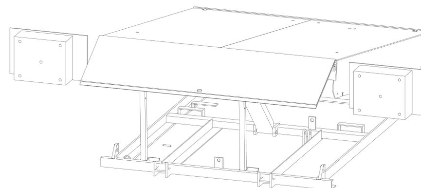
Obra requerida por parte del cliente para instalar la rampa de andén mecánica
