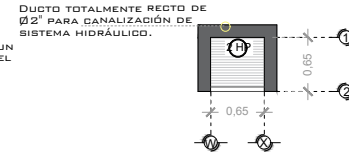
DESCRIPCION DE UNIDAD HIDRAULICA GABINETE (VISTA PLANTA)
