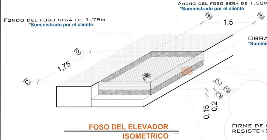
OBRA CIVIL PARA EL ANCLAJE DEL EQUIPO
