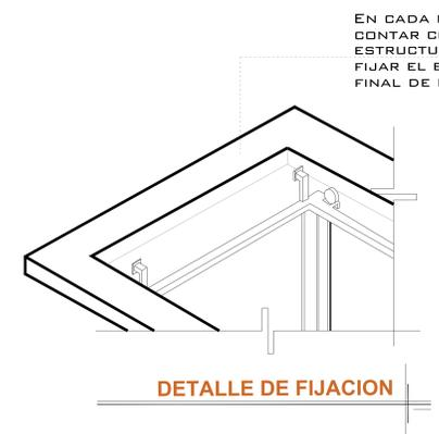
EN CADA ESTACIÓN DEBERÁ DE CONTAR CON UN ELEMENTO ESTRUCTURAL DEL CUAL SE PUEDA FIJAR EL EQUIPO, ASÍ MISMO COMO AL FINAL DE LAS COLUMNAS DEL MISMO.
