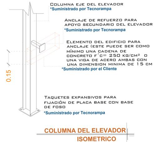
EL MURO DEBERÁ DE SOPORTAR Y DAR FIRMEZA A LA ESTRUCTURA DEL ELEVADOR. SE REQUIERE QUE EL ÁREA DONDE SE COLOQUEN LOS SOPORTES SEA UN MURO COMPLETO DE CONCRETO SI NO ES ASÍ, EL ÁREA DE CONEXIÓN DEBERÁ DE SERLO EMPLEÁNDOSE PARA ELLO UNA TRABE O CADENA DE CERRAMIENTO REFORZADA CON UN PERALTE MÍNIMO DE 15CM.
