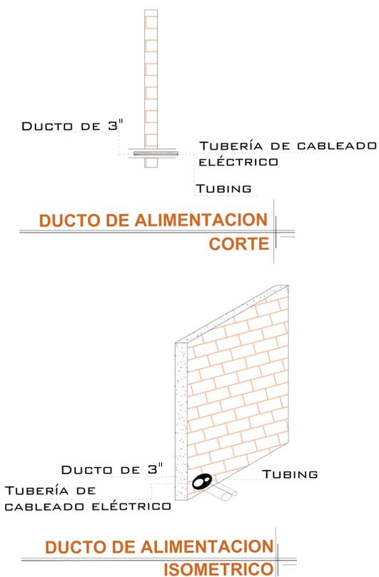
LA DISTANCIA "B" SE CUBRIRÁ DE SER POSIBLE CON DUCTOS REALIZADOS CON TUBERÍA Y LA SALIDA EN EL FOSO SERÁ RECOMENDABLE UBICARLA DEL LADO DONDE SE ENCONTRARAN LAS COLUMNAS Y EL RESTO DE LA ESTRUCTURA DEL ELEVADOR. EN CASO DE QUE NO SE PUEDA INSTALAR ESTOS DUCTOS SE EMPLEARA UNA CANALIZACIÓN DIFERENTE QUE PROTEJA EL CABLEADO. EN CUALQUIERA DE LOS DOS CASOS ESTÁ SERÁ SUMINISTRADA POR PARTE DE TECNORAMPA Y LOS TRABAJOS PARA SU INSTALACIÓN LO HARÁ EL EQUIPO DE LA EMPRESA.
