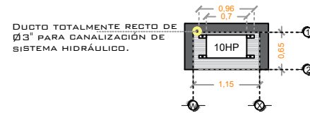
DESCRIPCIÓN DE UNIDAD HIDRAULICA GABINETE (VISTA PLANTA)
