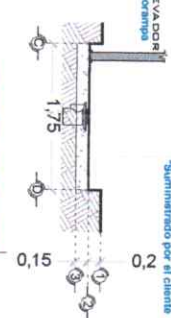
FOSO DEL ELEVADOR VISTA LATERAL
