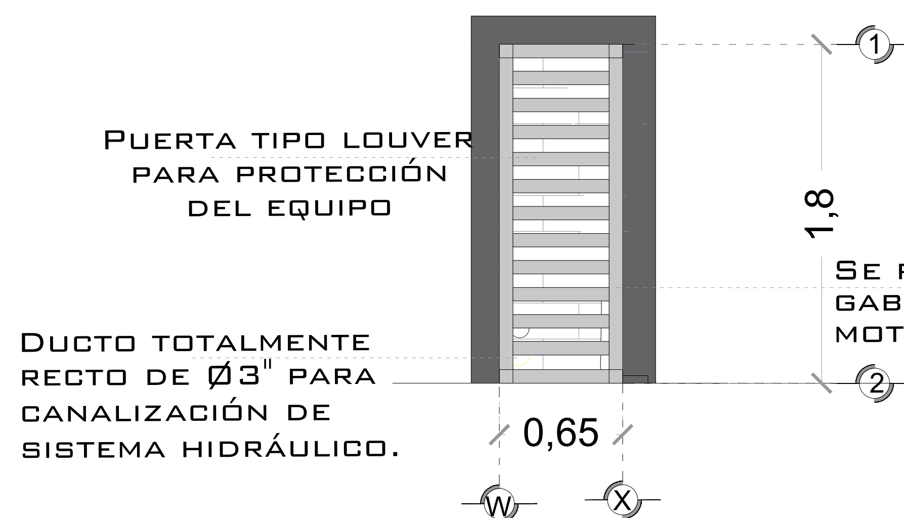
DESCRIPCION DE UNIDAD HIDRAULICA GABINETE (VISTA FRONTAL)
