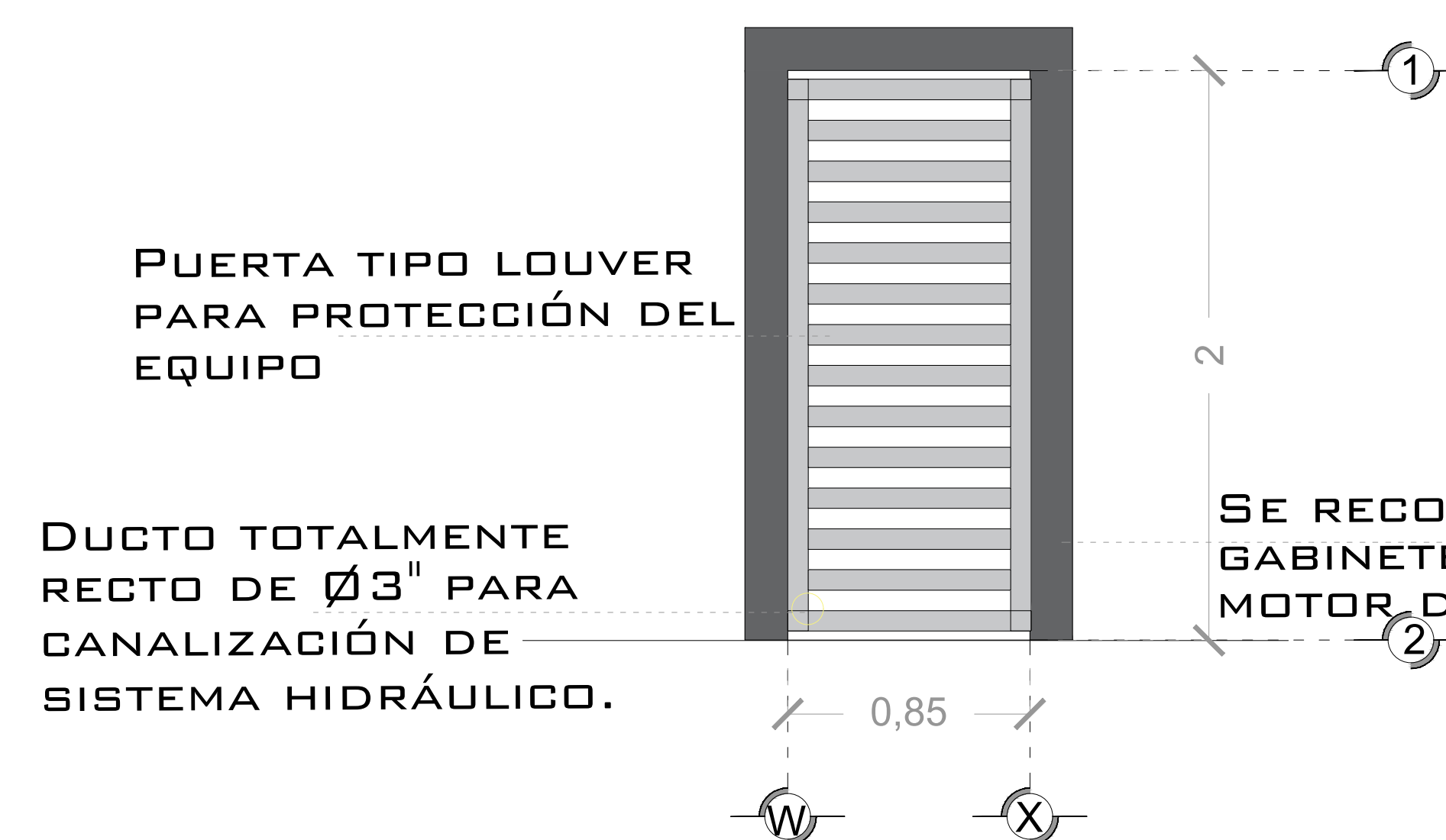
DESCRIPCIÓN DE UNIDAD HIDRAULICA GABINETE (VISTA FRONTAL)
