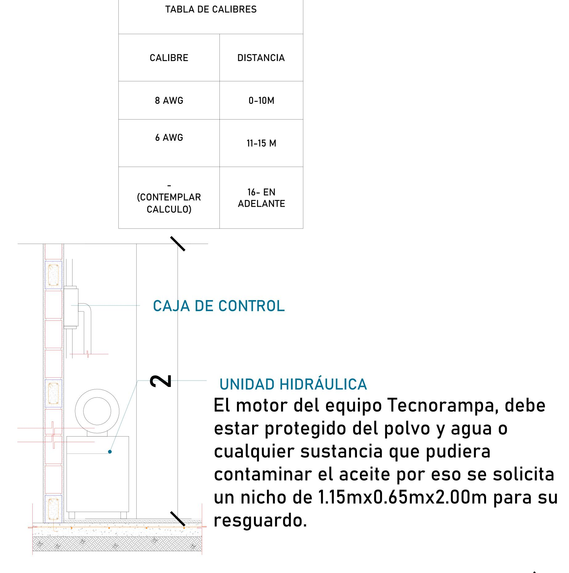
El cliente suministra, instala y energiza centro de carga con alimentación trifásica a 220V, con neutro y tierra física, e interruptor termomagnético de 3 x 40 Amp exclusivo para el elevador, deberá colocarse en el área donde se ubique la unidad hidráulica y control eléctrico proporcionado por TECNORAMPA a no mayor de 5.00m del área del equipo.
