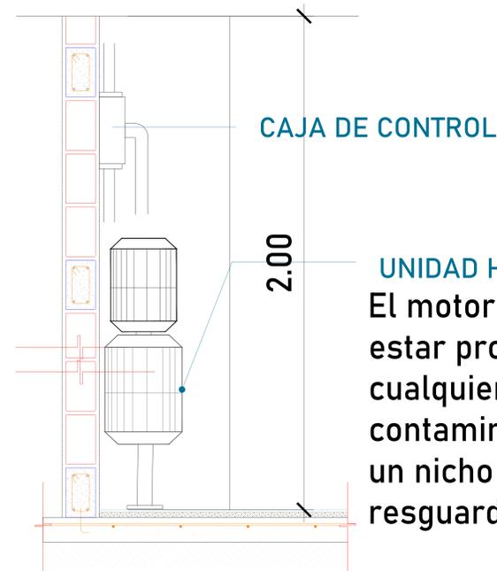
El cliente suministra, instala y guía tubería de 3/4" para botoneras, dejando chalupa en cada estación y canalización en escalera a las estaciones subsecuentes, remata a caja registro de 4" x 4", ubicada en área donde se ubique la unidad hidráulica y control eléctrico proporcionado por TECNORAMPA, a no mayor de 5.00m del área del equipo.
