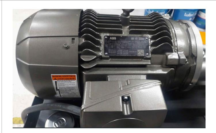
MOTOR ELECTRICO TRIFASICO PARA INYECCION DE ACEITE
